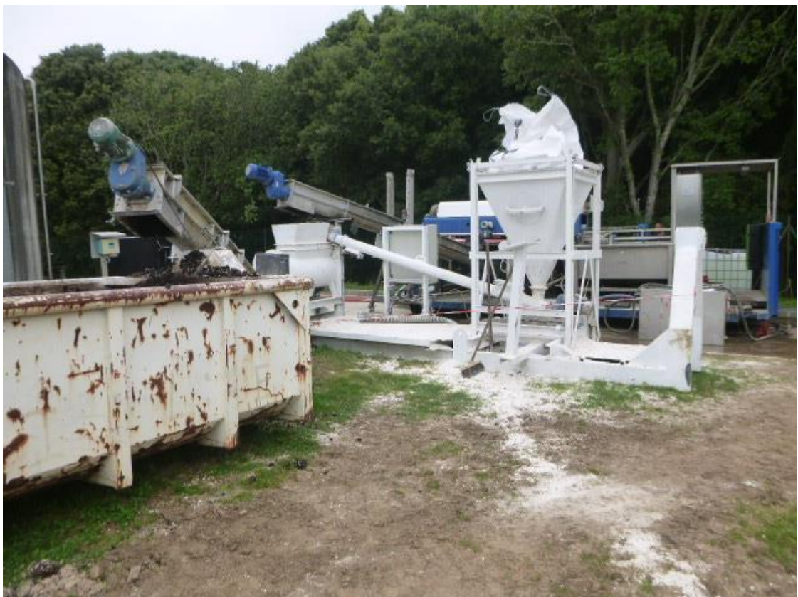
STEP de Bruté : unité mobile d'hygiénisation (déshydratation et chaulage) des boues du silo
